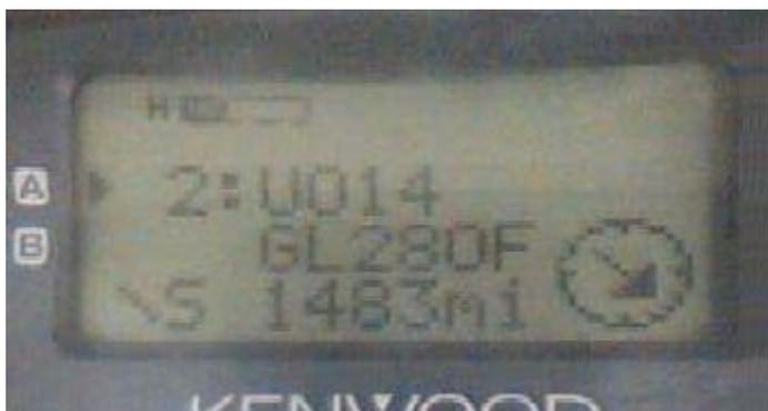
第一张图片显示了 DX-SPOT 列表，显示在接下来的 80 分钟内以及何时出现三颗卫星 UO22、AO27 和 UO14。此时间表每 10 分钟更新一次。仅当卫星在视野内时才会传输接下来的两个屏幕。它们显示距离、方位角、上行链路和下行链路频率、多普勒和到卫星的距离。非常适合瞄准您的手持天线。有关更多详细信息，请参阅 [APRS 卫星资源](#)。
