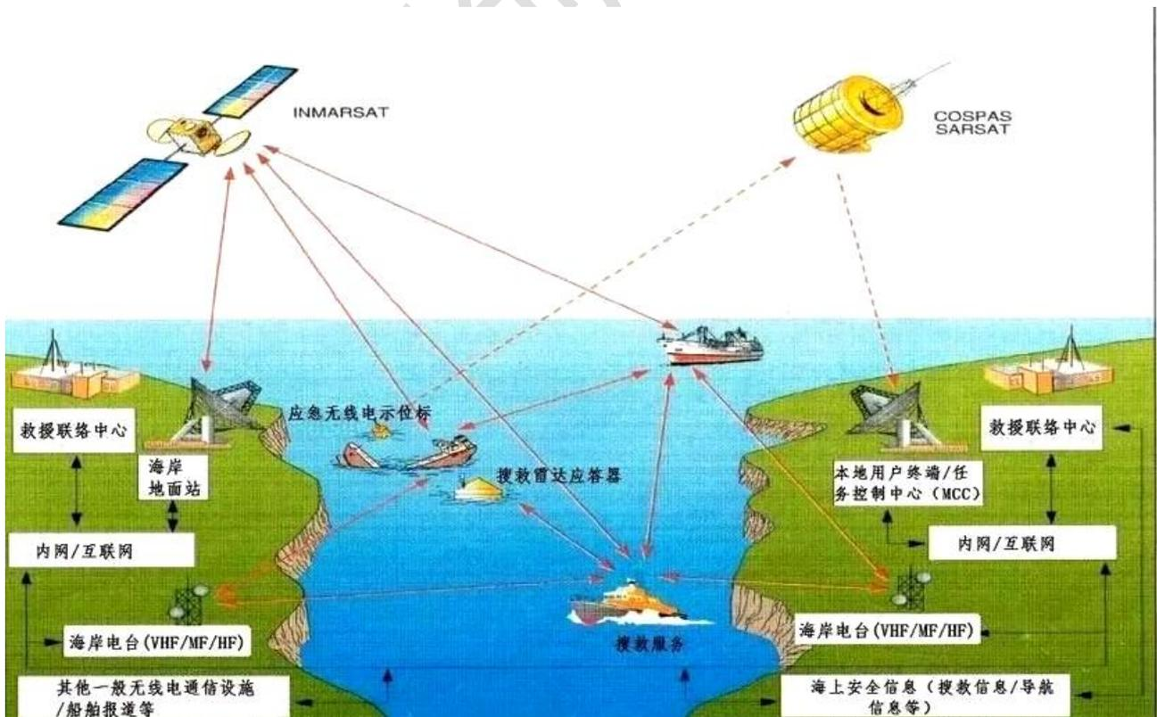
地面无线电通信系统，包括船用 Inmarsat - A/B/C/M//D/F/E 等船站以及各种数字选择
