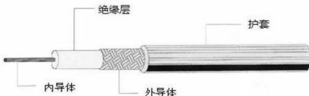
图3 射频同轴电缆
