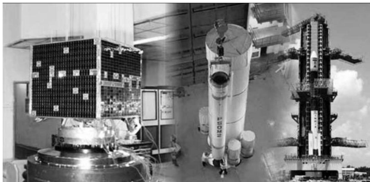
图3 发射前 VO-52 及其 PS LV-6 运载火箭 (AMSAT-India 提供提供) 两个转发器都以“U/V 模式”工作, 上行链路为 435MHz, 下行链路为 145MHz。在 145.936MHz 上的未调制载波是用来识别印度转发器, 而荷兰的转发器在 145.860MHz 发射 CW 信号。两个转发器的输出功率约为 1 瓦。印度的转发器带宽约为 60KHz, 荷兰转发器的带宽约为 50KHz。没有足够的功率来同时运行两个转发器, 因此一次只能激活其中的一个。**怎么接收、何时接收、在哪接收** 2005 年发射以来, VO-52 已成为一颗受欢迎的线性 (模拟) 转发器卫星。通过 1 瓦转发器和旋转天线, 即使用最简单的阵列天线, 也能提供惊人的高功率下行信号。然而, 由于 VO-52 处于相对较低的轨道 (646Km×607Km), 移动速度比大多数低轨卫星要快得多, 地球站覆盖区略小, 过境时间大约 15 分钟左右, 上行和下行信号多普勒频移明显。这需要重新设置一组新的轨道根数在卫星跟踪软件中运行, 以确保获取卫星通过地球站的准确时间。
