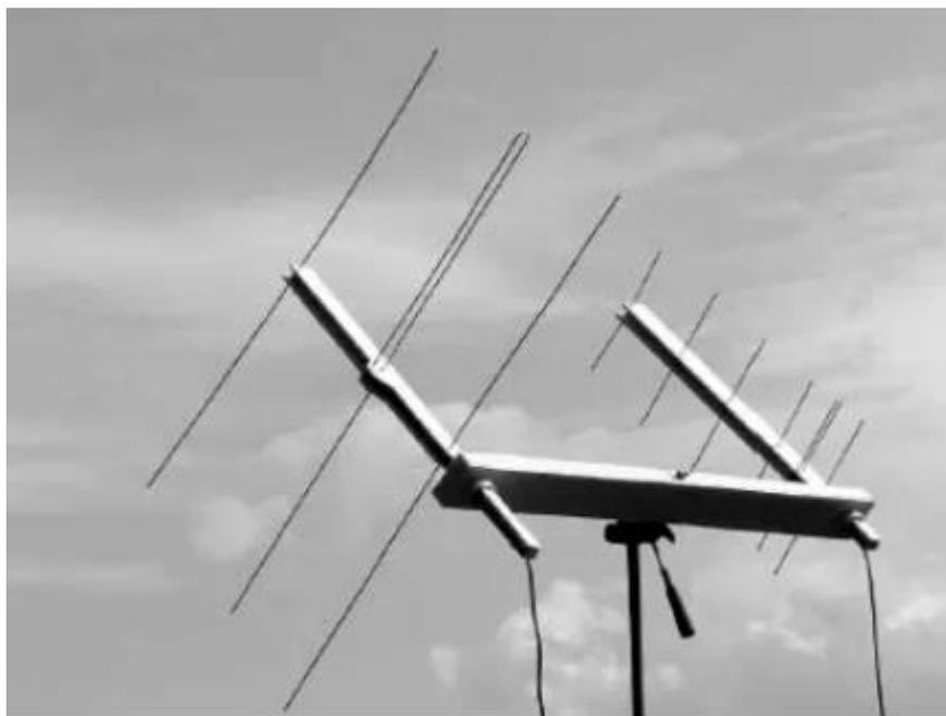
图1 一对安装在木质横杆上，由铁丝和木头自制的垂直极化八木天线
