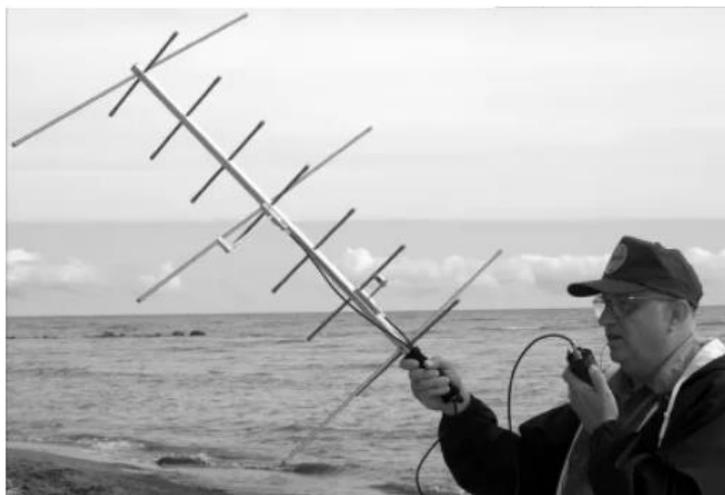
图 4 作者正用一台建伍 TH-78A 双频段对讲机和一副轻量化天线通过 AO-51 进行通信。在空旷、无遮挡的地带，只输出功率 5W 也能在 FM 卫星刚出现在地平面以上进行通信。
