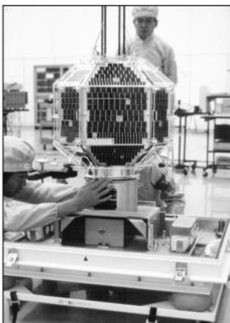
图1 技术人员对 JAS-1b 发射流程做最后的准备, 卫星装有线性转发器, 在轨后命名 FUJI-OSCAR 20 (FO-20) (JAMSAT 提供)
