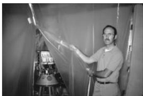
图2 AO-7 的总装“净室”是用钉木和塑料布制成，尽管简陋，AMSAT 从未有一颗卫星因为污染而被发射机构拒绝。(AMSAT 提供) 与 AO-6 类似，AO-7 由多个国家 (德国、加拿大、美国和澳大利亚) 爱好者在 AMSAT-NA 指导下共同建造。卫星搭载非反向 A 型 (V/A 型) 和反向 B 型 (U/V 型) 线性转发器。10m 波段和 2m 波段的遥测信标以组件的方式附着在圆形卫星的表面。遗憾的是，AO-7 的 2304.1MHz 实验信标因国际频率划分的原因，从未被激活。
