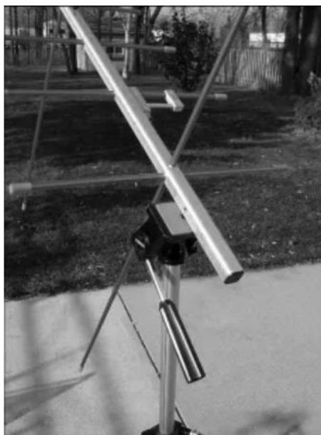
图6 卸下双工器和泡沫把手，将天线安装到三脚架 (KB1SF 提供)
