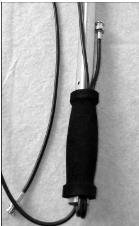
图2 2m/70cm 型天线将一个 10W 的双工器塞在泡沫把手内 (KB1SF 提供)
