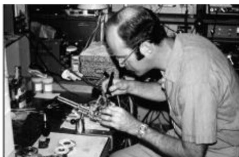
图1 早期，爱好者经常在他们的地下室或花园里建造业余卫星，图中是 Dick Daniels (W4PUG)，正将电子元器件焊接到 AO-7 的电子设备模块 (AMSAT 提供) 这颗重量约 30 公斤的八面体卫星 (高 360mm，直径 424mm) 被发射至倾角为 101.7 度，近地点和远地点分别为 1444km 和 1459km 的近似圆轨道。卫星天线阵由倾斜可旋转的圆极化 VHF/UHF 频段天线系统和 HF 频段偶极子天线组成。
