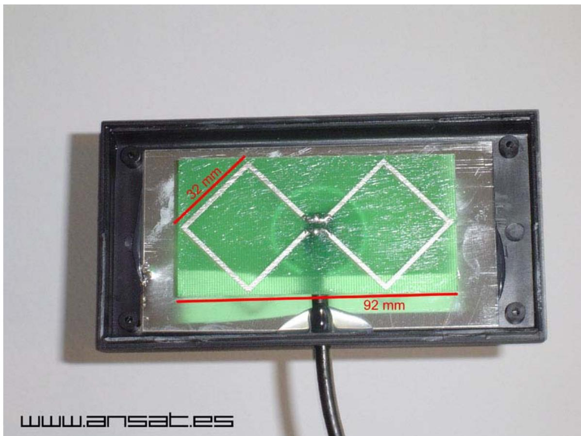
图中细线条的宽度 1.5 毫米.
