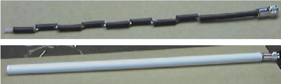
使用 15 毫米或 22 毫米铜管和 10 毫米直径的 RG-213 电缆, 37+6+6+1=50 毫米,8 小段+1/4 波长总共天线长 420 毫米.
