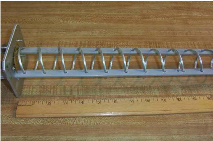
这个支撑板是两根 PVC 板 277mm,每隔 60mm 打个孔.
