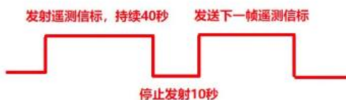
图 2 希望一号卫星的信标时序图
