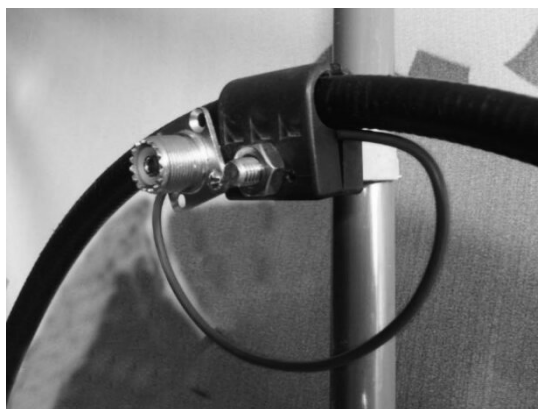
图 6-39 耦合环直接焊在 M 座上
