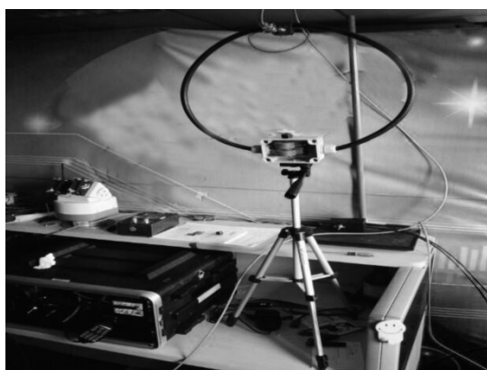
图 6-40 将小环天线固定在三脚架上
