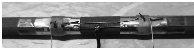
图6 分段对称绕制于内屏蔽上的线圈
