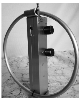
图1（b）将环形天线安装在侧面的测向机
