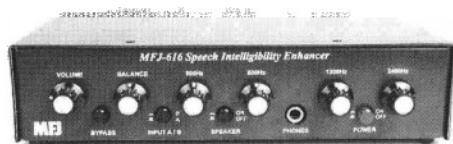
图 10.19 一个可用的商品化语音清晰度增强器，MFJ-616。这种设备对补偿讲话范围内的听力损失非常有用。
