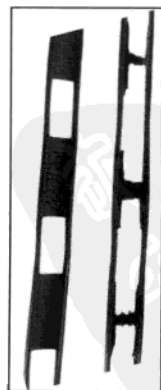
图 8.23 右侧隐形梯形馈线。由原来的梯形馈线，用指甲刀修剪扩大而成。馈线最后被喷成炭黑色。
