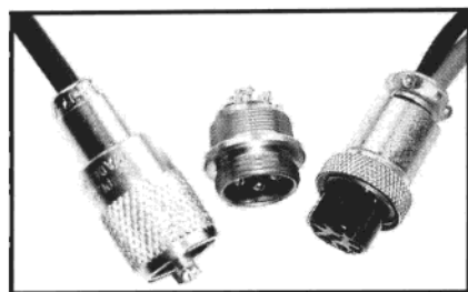
图 1.9 用于构建话筒延长线母头的零件。左边为 PL-259，中间是底盘安装的话筒连接器（图中显示了 4 个针脚，也可以使用 8 个针脚），右边是话筒插头。
