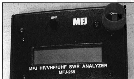
图 1.18 这里使用的电源开关保护装置是红色塑料帽，它通常用来盖住 RF 连接器。其他的开关保护装置也开始使用塑料瓶盖进行制作。
