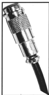
图 1.11 完工之后的延长线母头。将合适的话筒插头接到延长线的另一头，以构成完整的延长线。
