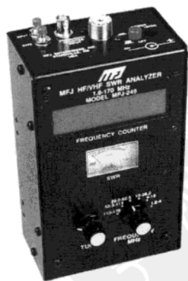
图 8.16 便携式天线分析仪对于测量天线和馈线的特性非常有用，它自身具有射频信号输出功能，因此不需要发射机的参与。
