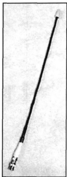
图 10.8 KO4ALA 自制的应急可弯曲天线，详细制造过程见正文部分。
