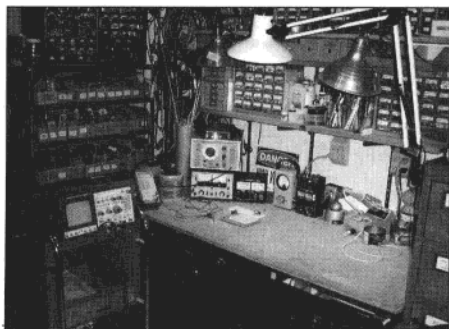
图 10.14 工作台上面，你可以看到我最经常使用的设备。零件盒里装了大量的元件，还有一个小的废料箱。示波器在一个小推车上上面。
